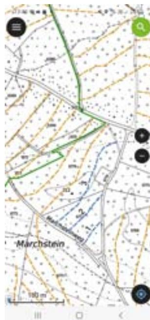
Abbildung 5: Farblich zu unterscheiden: bestehende Gassen braun, neu aufgenommene blau inkl. Nummerierung.
