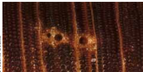
Abbildung 2: Harzkanäle im Übergangsbereich von Früh- zu Spätholz
