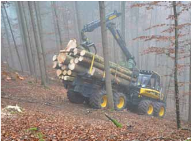
Abb. 1: Forwardereinsatz mit Traktionswinde bei ca. 50% Hangneigung.
