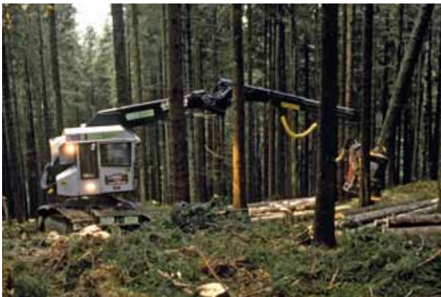
Abb. 2: Fällen und Aufarbeiten mit einem Raupenvollernter am Hang in einem Fichtenbaumholz. Die Maschine befährt dabei die von ihr selbst angelegte Reisigmatte, um den Boden zu schonen und Wurzelverletzungen zu vermeiden.
