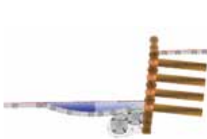
Einfache Holzsperrre aus Lärche; geplant und nach Ausführung
