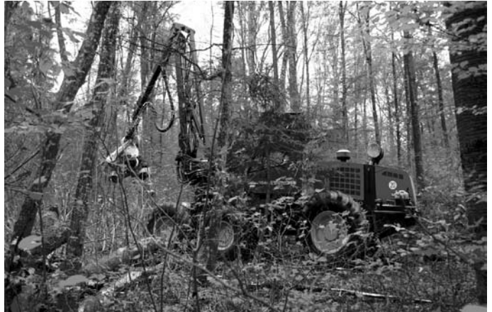
Vollerntereinsatz im stufigen Laubmischwald bedingt eine konsequente Feinerschliessung mit Rückegassen.
