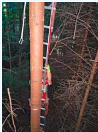
Abbildung 2: Das kürzere aufklappbare Element wird aufgesteckt.
