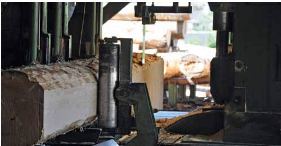
Starkholz auf einer Blockbandsäge
