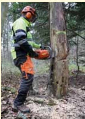
Drahtseil montiert, Fallkerbe gemacht, stechen und ein Halteband lassen.
