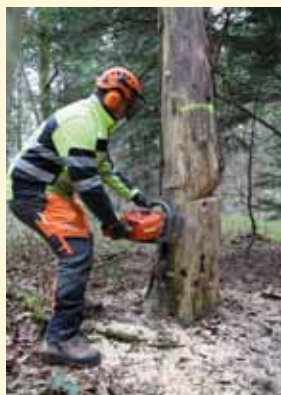
Das Halteband wird «negativ» durchtrennt
