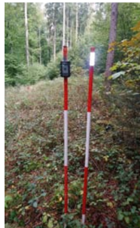
Abbildung 2: Jalon können von Vorteil sein bei der Feldarbeit. Jalon links mit GPS-Gerät, Jalon rechts mit Velolicht für bessere Sichtbarkeit und Orientierung.
