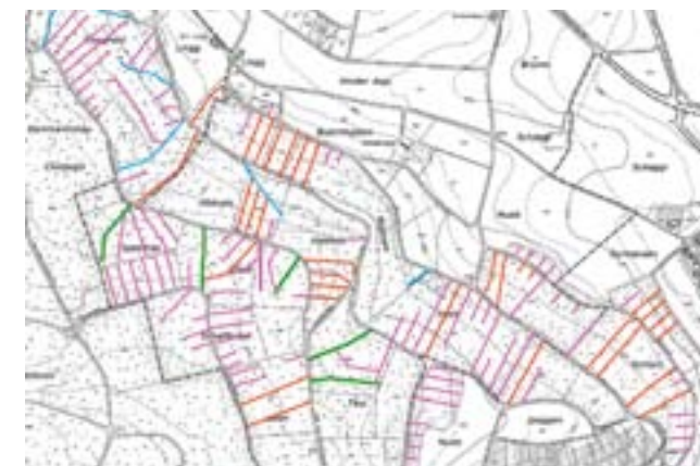
Abbildung 1: Das Feinerschliessungsnetz im Überblick. Die Farben der Feinerschliessung beschreiben die Art der Rückegassen: rot = durchgehende Rückegasse, violett = Stumpengasse, blau = alter Maschinenweg, grün = «Hauptgasse», Traktorspuren der Privatwaldeigentümer, welche seit Jahrzehnten befahren werden.
