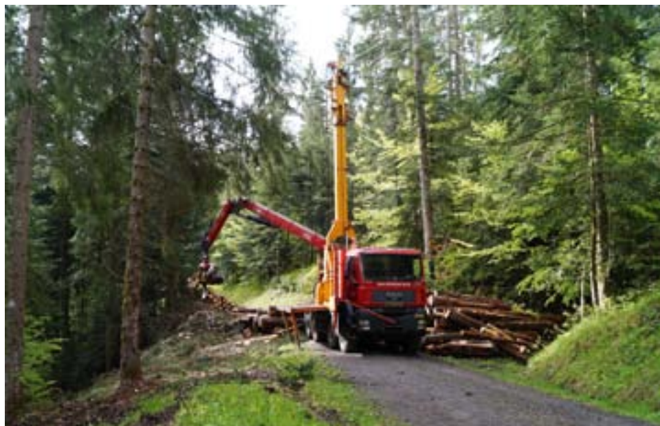
Abbildung 1: Der K507 ist auf einem LKW montiert und arbeitet aufgrund der horizontalen Rückerichtung mit einem Drei-Seil-System
