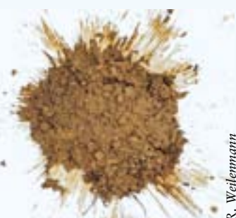
«Spritzer» unregelmässig und flach; Befahren ausgeschlossen, Arbeit einstellen
