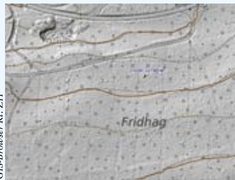
Auf dem Orthofoto (oben) sind nur wenige Gassen sichtbar. Im Digitalen Höhenmodell (LiDAR) sind sogar die Doppelspuren der Forstmaschinen erkennbar. Da das Orthofoto das neuere der beiden ist, zeichnen sich einige deutliche Rückegasse-Schneisen im LiDAR noch nicht ab.
