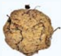
Risse in der Oberfläche, fällt u.U. ab; Befahren problemlos möglich
