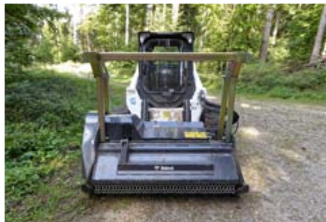
Abbildung 3: Dieser Bobcat mit Forstmulcher ist eine äusserst manövrierfähige Möglichkeit, um die Gassen zu mulchen. Als Allrad ist er allerdings nur in einfachem und tragfähigem Gelände einsetzbar. Mit einem Raupenfahrwerk jedoch fährt er überall, wo auch Forstmaschinen fahren können.
