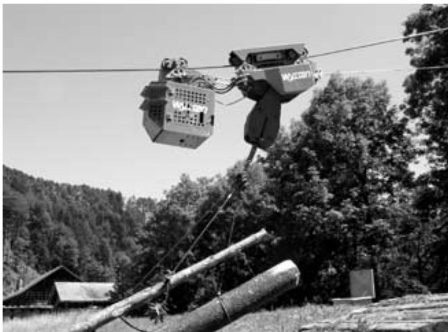
Wyssen-Laufwagen HY4, funkgesteuert mit Motorausspuler und Zugseilklemme
