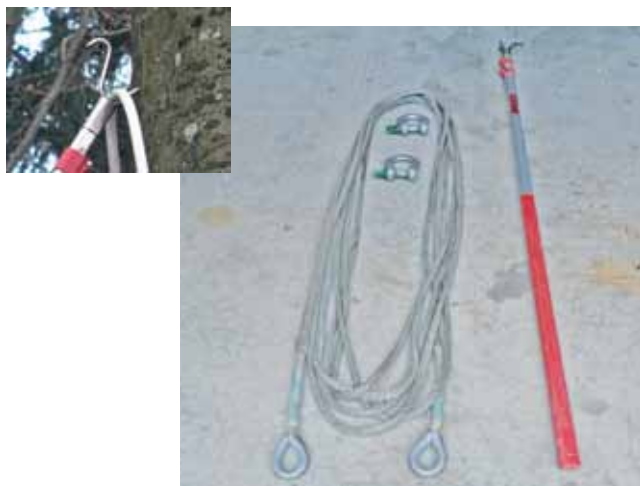
Nylonseil, Schäkel und Teleskopstange
