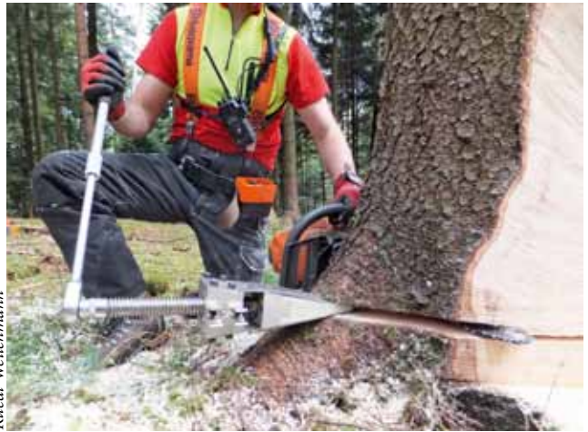
Um den Keil gut ansetzen zu können, wird der Fällschnitt im «Keilbereich» in doppelter Schnittstärke gesägt.
