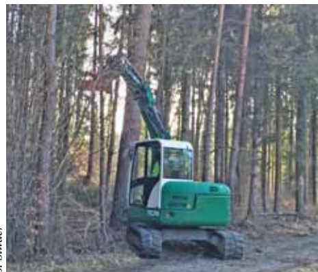
Der Fällsammler kann bis ca. 7 Meter in den Bestand hinein greifen.
