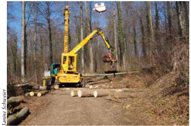
Abbildung 1: Einsatz des Kombiseilgerätes Koller K507 in ebenem Gelände
