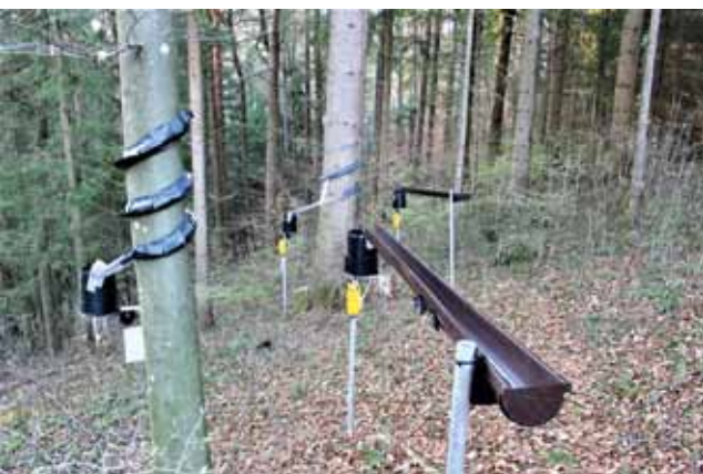
Abbildung 1: Die Abflussmessstation am Holderbach (links) und die Installationen zur Messung von Bestandsniederschlag und Stammabfluss (rechts).
