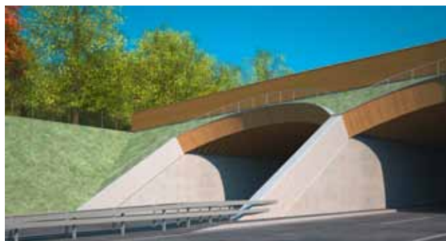
Geplante Wildbrücke Rynetel AG. Doppelbogenkonstruktion aus gekrümmten Holzträgern. Abdeckung mit Sperrholzplatten. Lagerung mittels Stahlgelenken auf Stahlbetonwänden. Gründung auf Bohrpfehlen.
