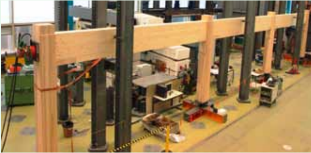
Abb. 2: Push-over-Versuche an einem vorgespannten BSH Träger mit 3 Feldern auf dem Ausspannboden der HIF Bauhalle an der ETH Zürich Hönggerberg
