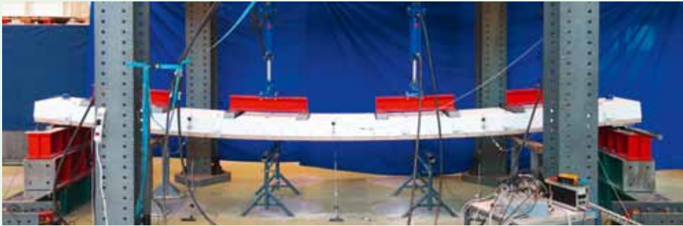
Abb. 3: Duktile Tragverhalten der entwickelten Holz-Beton-Verbunddecke mit Furnierschicht-holzplatten aus Buche
